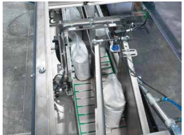
Deviatore affiancatore confezioni Sorting device equipped with diverter
